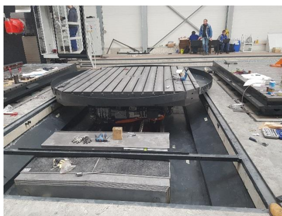
Horizontalni CNC obdelovalni center WRF 150 CNC (del. območje osi X/Y/Z/W osi 15,3/ 4,1,2/ 1 m)
