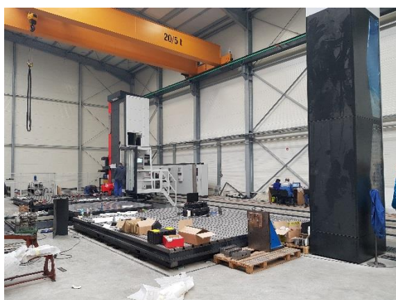
Horizontalni CNC obdelovalni center WRF 150 CNC (del. območje osi X/Y/Z/W osi 15,3/ 4,1,2/ 1 m)
